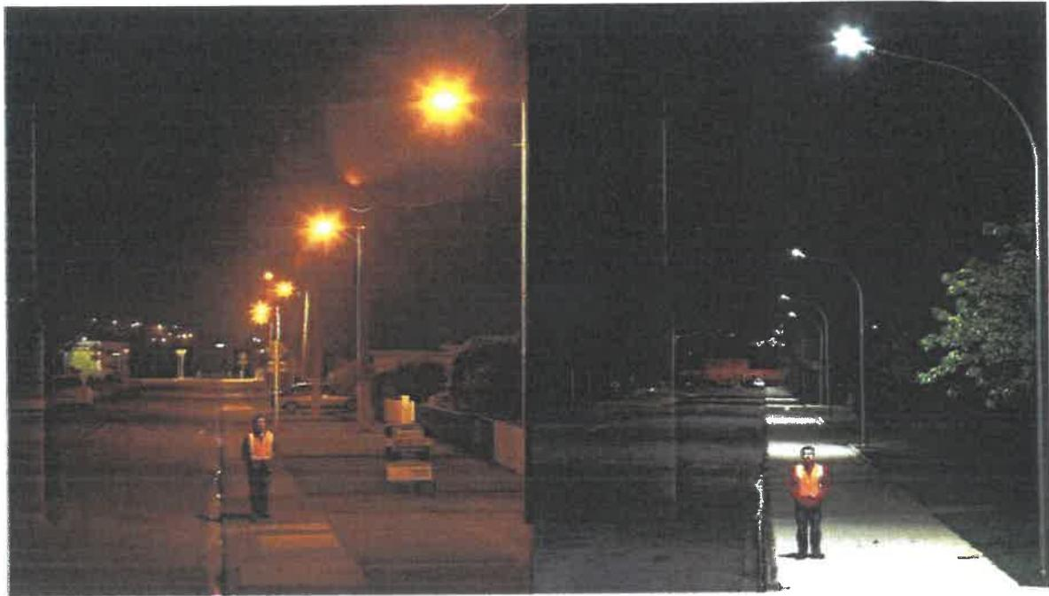
**Fig. 1.2. Comparatie intre sistem de iluminat cu vaporii de sodiu de inalta presiune si sistem de iluminat cu LED**
